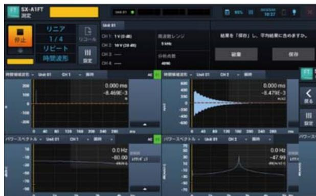
加振力・加速度の時間波形とパワースペクトル
