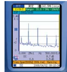
包絡線処理後のスペクトル
